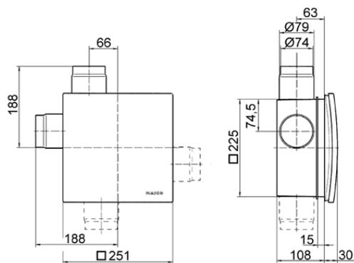
Вентиляторный узел ER с корпусом скрытого монтажа ER-UP/G или ER-UPD и двухкомнатным присоединением
