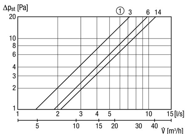
① Положение клапана в мм
